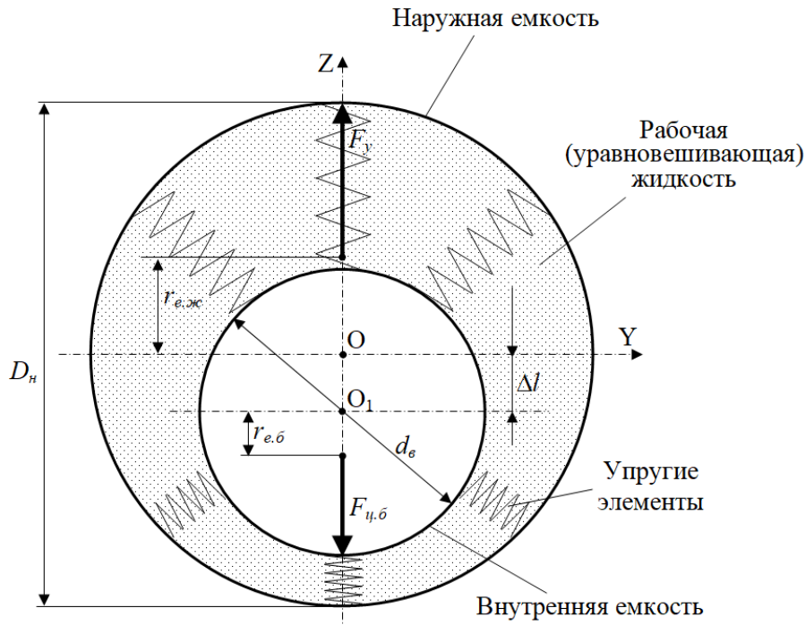
Рис. 1. Принципиальная схема рассматриваемой конструкции жидкостного АБУ пассивного типа: D_n — диаметр наружной емкости; d_v — диаметр внутренней емкости; r_{e.б} — эксцентриситет центра масс текстильных изделий (белья); r_{e.ж} — эксцентриситет центра масс кольца уравновешивающей жидкости; \Delta l — силовое перемещение внутренней емкости; F_{ц,б} — силовое воздействие на внутреннюю емкость в виде центробежной силы от неуравновешенных масс текстильных изделий (белья); F_y — уравновешивающая сила
