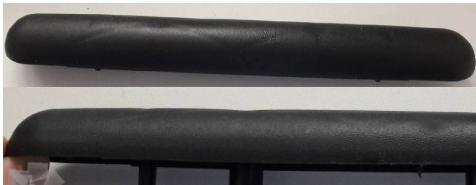
Рис. 5. Внешний вид изделия с дефектами поверхности, характерными для технологических параметров процесса, соответствующих исходной точке симплекса ( t_{рп} = 198\text{ }^{\circ}\text{C} , t_{пф} = 74\text{ }^{\circ}\text{C} и P_{рп} = 100\text{ МПа} )
