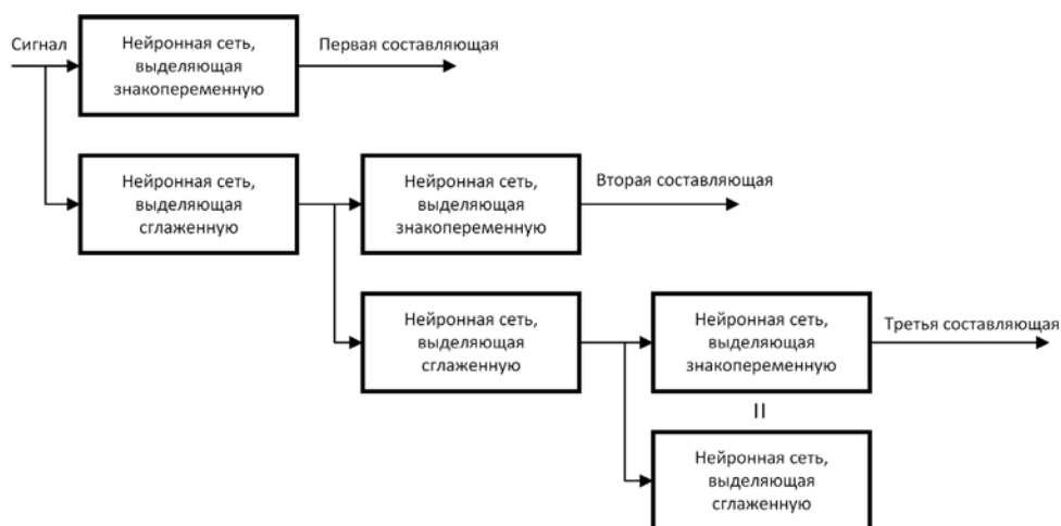
Рис. 2. Структура, реализующая выделения составляющих с помощью нейронных сетей
